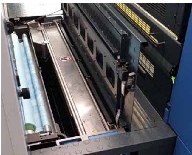
Utwardzanie UV na zespołach drukujących
